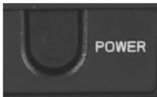
Выключатель электропитания расположен на передней стороне корпуса POS-компьютера. Этот выключатель контролирует включение/выключение системы. Он включает систему при нажатии на него только тогда, когда компьютер подключен к
