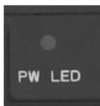
Рядом с выключателем питания расположен индикатор. Желтый цвет индикатора питания указывает на то, что система находится в режиме ожидания. При включении компьютера, этот индикатор становится синим.
