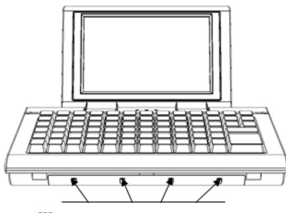
Рисунок 10. Крепление крышки аккумуляторного отсека
