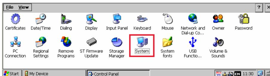
Дважды щелкнуть по значку «System» в папке, тем самым открыть окно «System Properties», затем перейти к вкладке «Device Properties».
